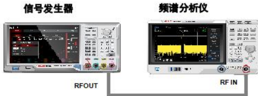
图 3-10: 获取单一信号的仪器设置
